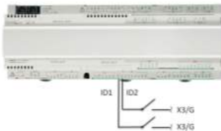
Fig.7.89 : Connexion des entrées ID 1 et ID 2
