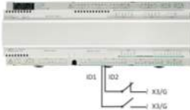
Fig.7.88 : Connexion de l'entrée ID 2
