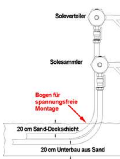
Fig. 3.6 : Installation des canalisations sur le distributeur de saumure
