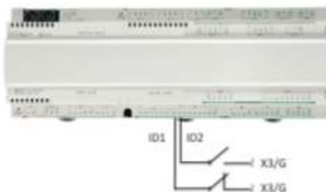
Fig.7.90 : Câblage de l'entrée ID 1
