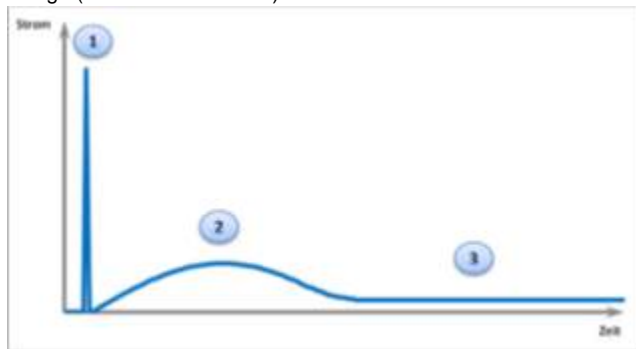
Fig.7.9 : Courants de démarrage pour les pompes de circulation
