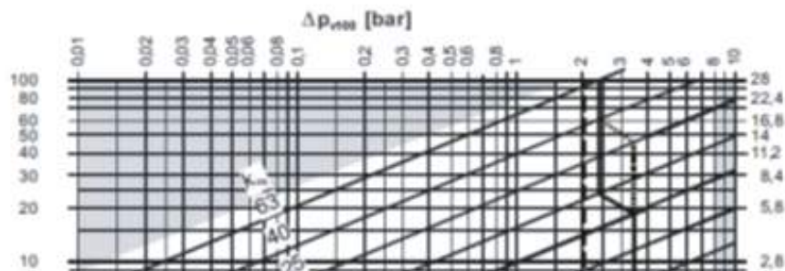
Fig.8.7 : Diagramme de perte de charge WWM 50
