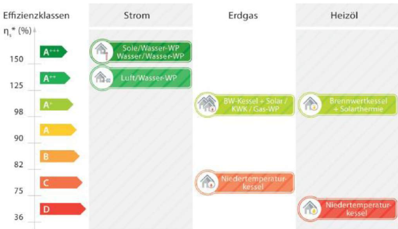
Fig. 0.6 : Comparaison du rendement de différents générateurs de chaleur
