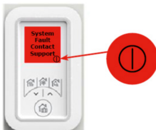
Fig. 62 : Fault Screen (Manual Mode)
